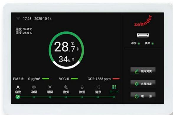
Zehnder Comfohomeの操作はタッチパネル。直感を大切にしたいUIデザインで簡単に操作できます。様々な機能を細かく設定できる画面構成、状態がひと目で分かる画面レイアウトなど使いやすさも大切にしました。Comfohomeの運転状況をグラフで表示したり、インターネットと接続すればスマートフォンから温度などの状況確認や遠隔操作が可能です。
